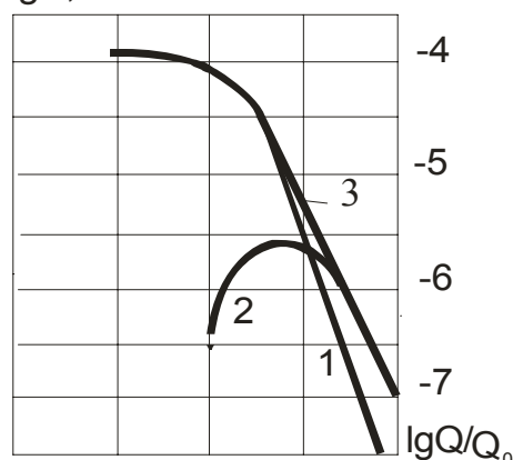
Рисунок 2 - Зависимость относительного запыления лицевой поверхности ГЗСИ от высоты ячейки
