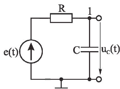
Рис. 6.13. Схема RC-цепи для наблюдения напряжения на конденсаторе
