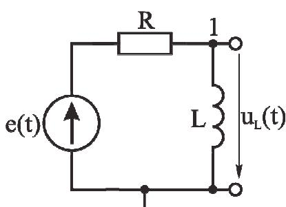
Рис. 6.14. Схема RL-цепи для наблюдения напряжения на индуктивности
