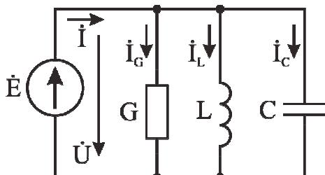
Рис. 5.7. Параллельный колебательный контур
