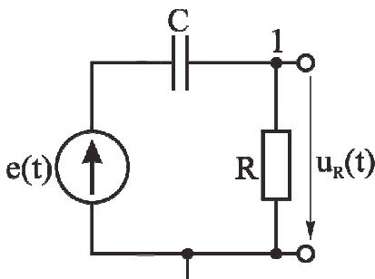
Рис. 6.12. Схема RC-цепи для наблюдения напряжения на резисторе
