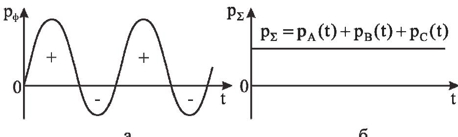
Рис. 3.4. Мощность фазы (а) и суммарная мощность (б) симметричной трехфазной системы ЭДС
