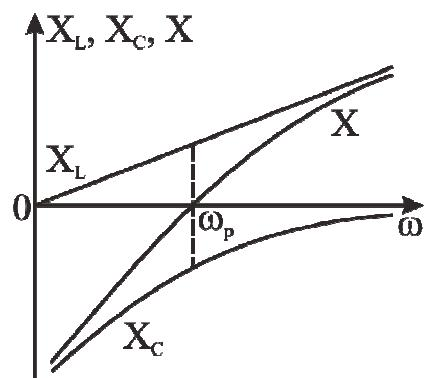
Рис. 5.2. Зависимость реактивных сопротивлений последовательного колебательного контура от частоты
