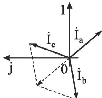
Рис. 3.8. Векторная диаграмма токов соединения «звезда» при симметричной нагрузке
