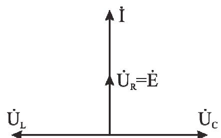
Рис. 5.3. Векторно-топографическая диаграмма последовательного колебательного контура для режима резонанса напряжений
