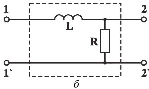
Рис. 8.12. Схемы дифференцирующей (а) и интегрирующей (б) RL-цепи
