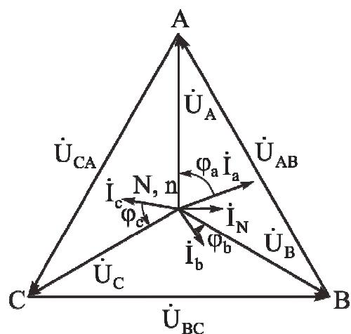
Рис. 3.10. Векторно-топографическая диаграмма соединения «звезда» при несимметричной нагрузке
