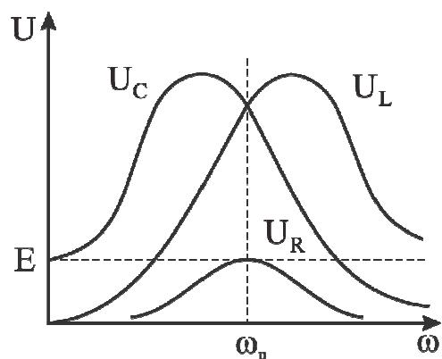
Рис. 5.6. Зависимости амплитуды напряжения на сопротивлении, индуктивности и емкости в последовательном колебательном контуре от частоты
