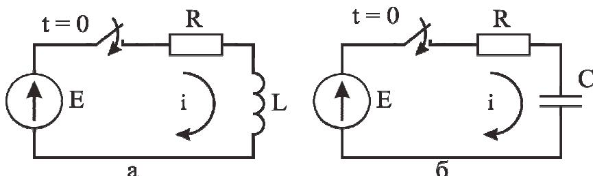
Рис. 6.2. Схемы RL- (а) и RC- (б) цепей I порядка
