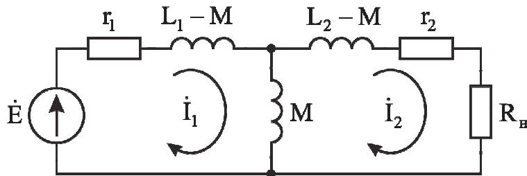
Рис. 2.8. Эквивалентная схема замещения трансформатора с коэффициентом трансформации  $n = 1$
