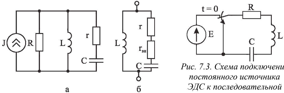
Рис. 7.2. Параллельный колебательный контур
