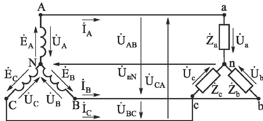
Рис. 3.11. Схема трехпроводного соединения фаз генератора и приемника «звездой»
