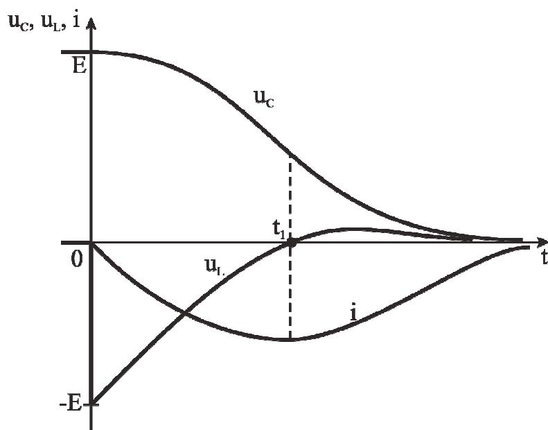
Рис. 7.4. Переходные процессы в RLC контуре для апериодического режима
