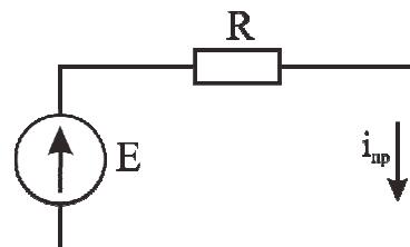
Рис. 6.5. Схема для определения принужденной составляющей в электрической цепи с источником ЭДС
