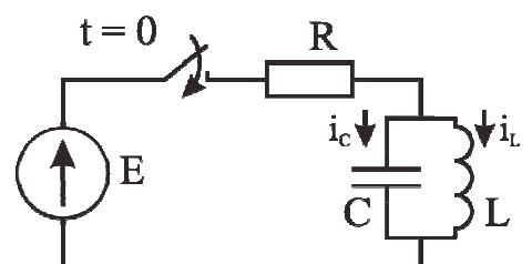
Рис. 7.6. Схема подключения постоянного источника ЭДС к параллельному  $RLC$  контуру
