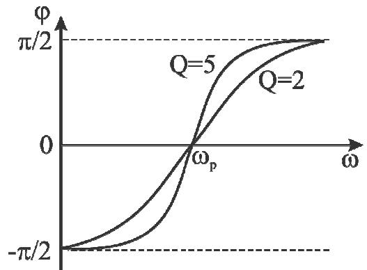
Рис. 5.5 Фазочастотная характеристика последовательного колебательного контура
