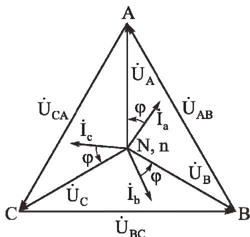
Рис. 3.7. Векторно-топографическая диаграмма соединения «звезда» при симметричной нагрузке
