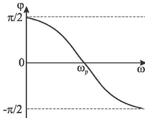
Рис. 5.11. Фазочастотная характеристика параллельного колебательного контура
