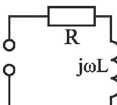
Рис. 6.4. Схема для расчета входного сопротивления
