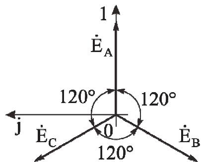
Рис. 3.2. Представление симметричной системы ЭДС на комплексной плоскости
