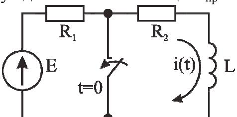
Рис. 6.7. Схема  $RL$ -цепи с ненулевыми начальными условиями
