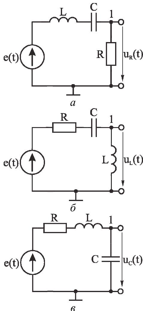
*Рис. 7.8. Схема исследования напряжений на сопротивлении (а), индуктивности (б) и емкости (в) в последовательной RLC-цепи*
