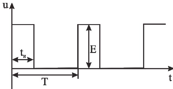
Рис. 6.10. Последовательность прямоугольных импульсов
