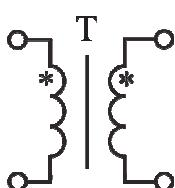
Рис. 2.6. Условное обозначение трансформатора
