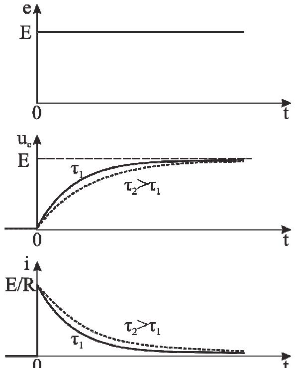
Рис. 6.9. Переходные процессы в RC-цепи при подключении источника постоянной ЭДС
