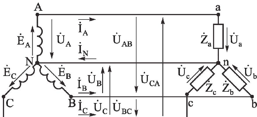
Рис 3.5. Схема четырехпроводного соединения фаз генератора и приемника «звездой»
