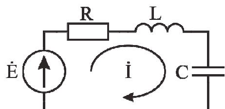
Рис. 5.1. Последовательный колебательный контур
