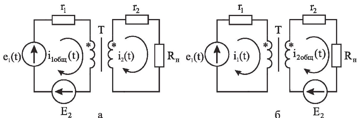
Рис. 2.10. Подключение постоянного источника ЭДС в цепь первичной обмотки трансформатора (а) и в цепь вторичной обмотки трансформатора (б)
