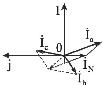
Рис. 3.9. Векторная диаграмма токов соединения «звезда» при несимметричной нагрузке
