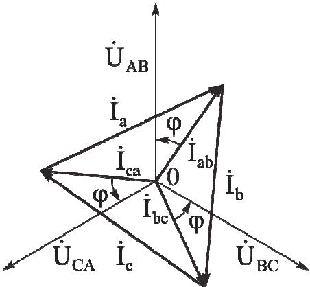
Рис. 3.14. Векторная диаграмма соединения «треугольником» при симметричной нагрузке приемника
