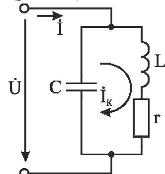
Рис. 5.9. Параллельный колебательный контур с потерями энергии
