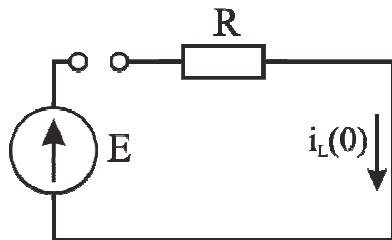
Рис. 6.3. Схема для расчета нулевых начальных условий в RL-цепи с источником ЭДС
