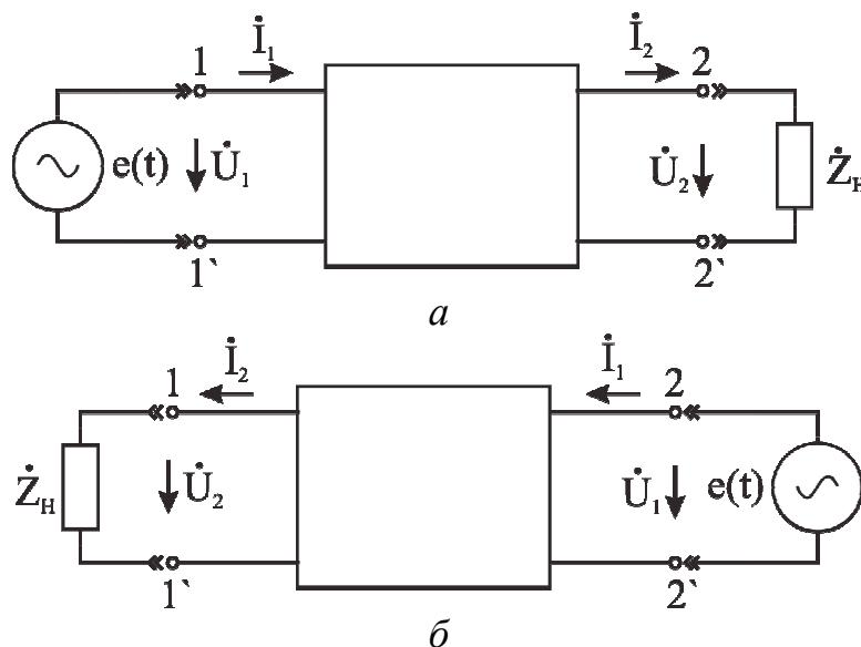
Рис. 8.2. Прямое (нагрузка включена со стороны выходных выводов - а) и обратное (нагрузка включена со стороны входных выводов - б) включение четырехполюсников
