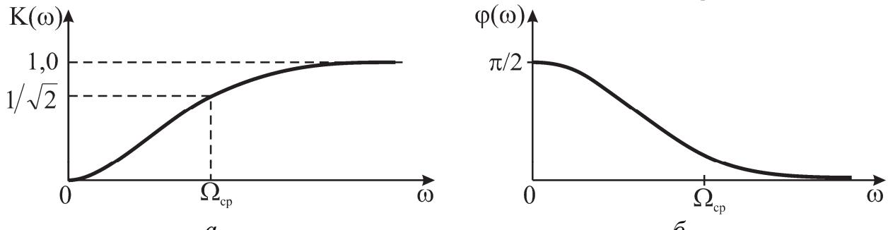
Рис. 8.9. АЧХ (а) и ФЧХ (б) переходной RC-цепи
