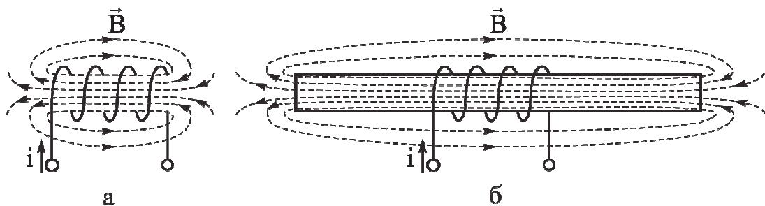
Рис. 2.1. Распределение линий магнитной индукции в соленоиде без магнитопровода (а) и в соленоиде с магнитопроводом (б)
