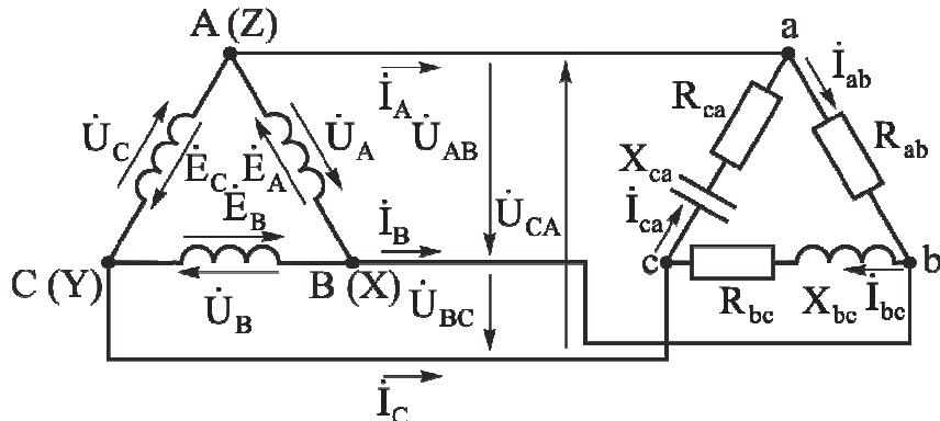
Рис. 3.15. Пример соединения фаз генератора и приемника «треугольником» при несимметричной нагрузке
