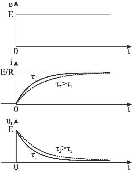
Рис. 6.6. Временные диаграммы переходного процесса в  $RL$  цепи при подключении источника постоянного ЭДС
