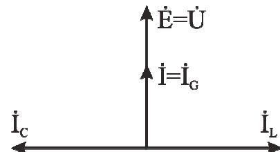
Рис. 5.8. Векторно-топографическая диаграмма параллельного резонансного контура для режима резонанса токов
