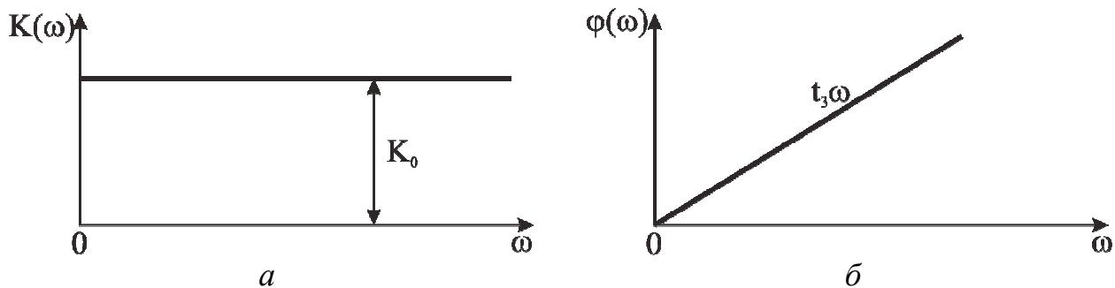
Рис. 8.5. Идеальные амплитудно-частотная (а) и фазочастотная (б) характеристики
