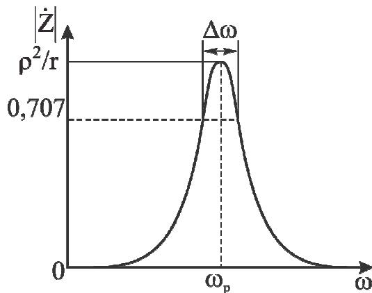
Рис. 5.10. Резонансная кривая параллельного колебательного контура
