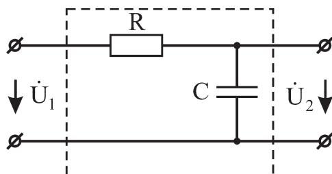
Рис. 8.6. Интегрирующая RC-цепь
