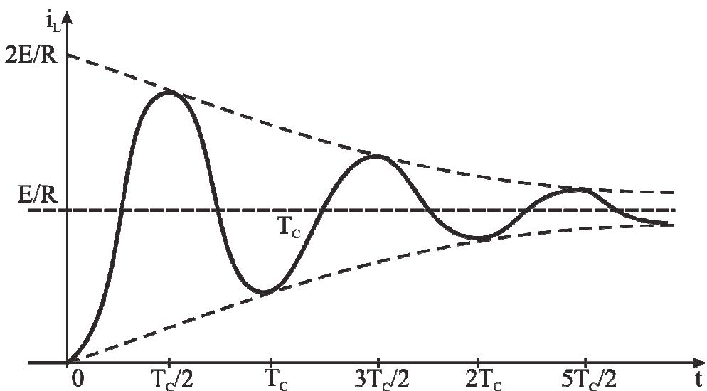
Рис. 7.7. Переходные процессы в параллельном контуре при подключении ЭДС
