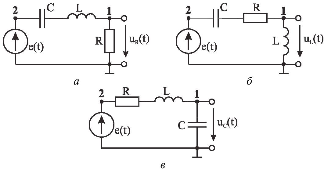
Рис. 5. 12. Схемы для наблюдения временных диаграмм на элементах последовательного колебательного контура:
