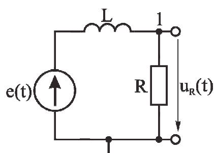
Рис. 6.15. Рис. 6.14. Схема RL-цепи для наблюдения напряжения на резисторе
