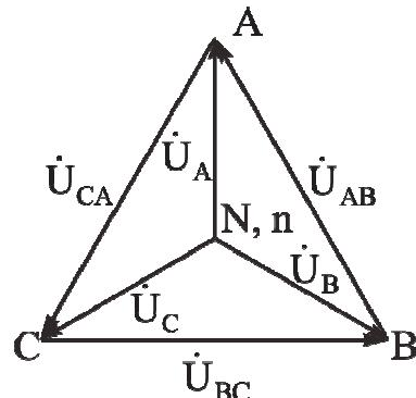
Рис. 3.6. Топографическая диаграмма фазных и линейных напряжений
