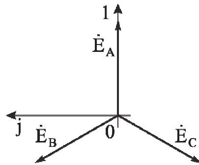
Рис. 3.3. Векторная диаграмма трехфазной симметричной системы ЭДС с обратной последовательностью фаз
