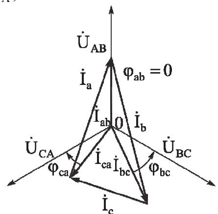
Рис. 3.16. Векторная диаграмма соединения «треугольником» при несимметричной нагрузке приемника
