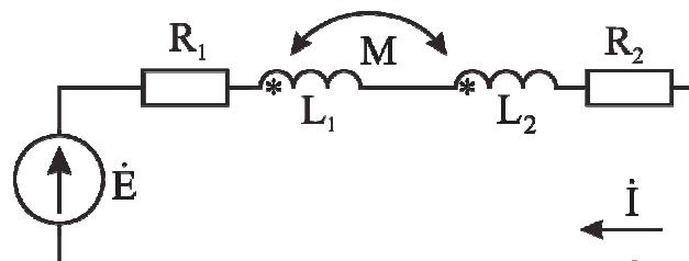
Рис. 2.4. Согласное последовательное соединение
