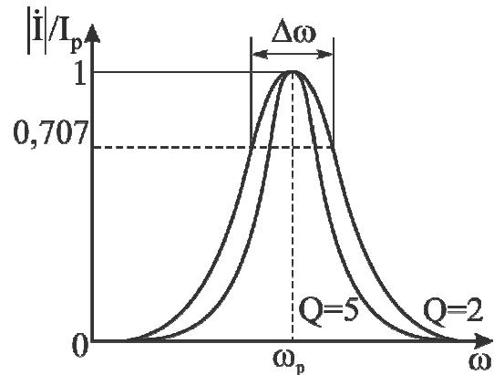
Рис. 5.4. Резонансные кривые последовательного колебательного контура
