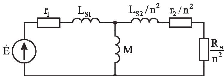
Рис. 2.9. Эквивалентная схема замещения трансформатора с коэффициентом трансформации  $n \neq 1$
