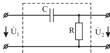
Рис. 8.8. Схема переходной RC-цепи
