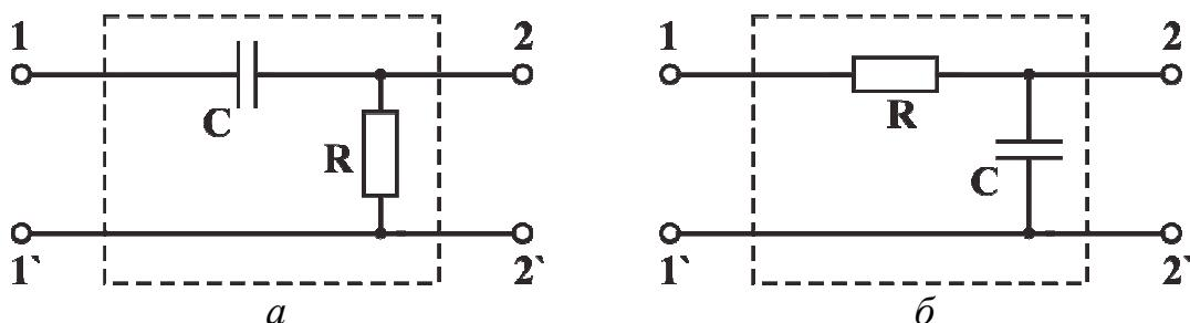
Рис. 8.11. Схемы дифференцирующей (а) и интегрирующей (б) RC-цепи
