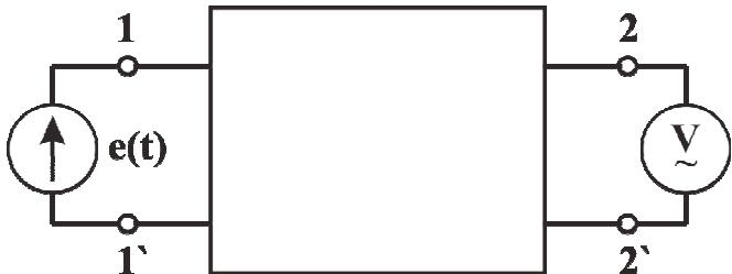
Рис. 8.10. Схема для снятия АЧХ линейных четырехполюсников
