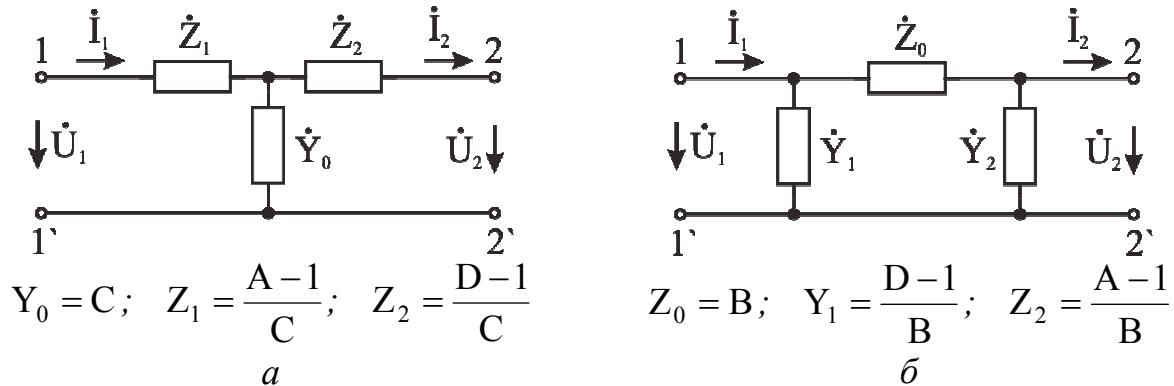
Рис. 8.3. Эквивалентные схемы замещения четырехполюсников Т- (а) и П- (б) образные, связь между параметрами четырехполюсника и его эквивалентной схемы в случае А-параметров
