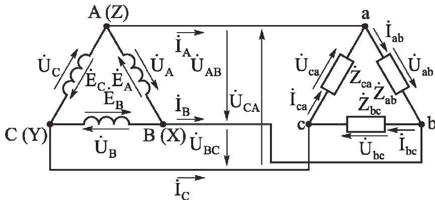
Рис. 3.13. Схема соединения фаз генератора и приемника «треугольником»
