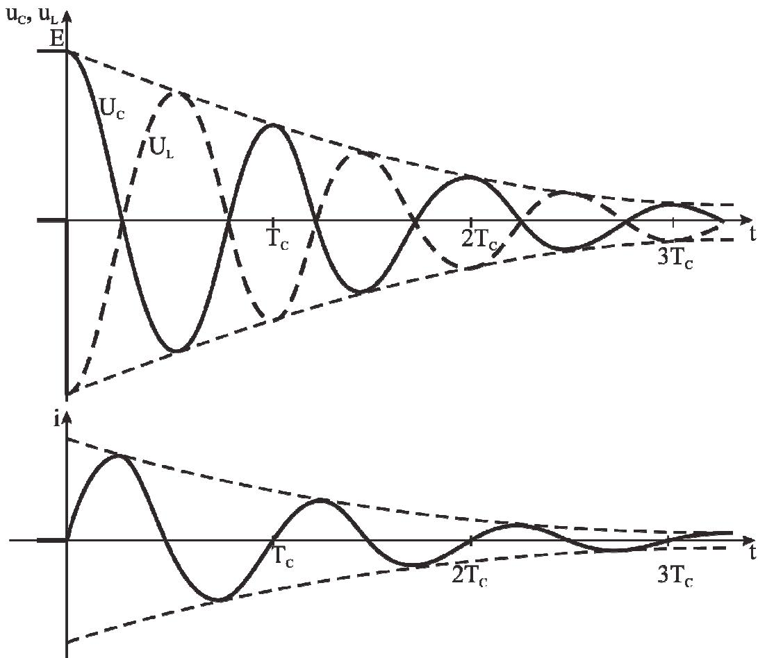
Рис. 7.5. Переходные процессы в  $RLC$  контуре для колебательного режима
