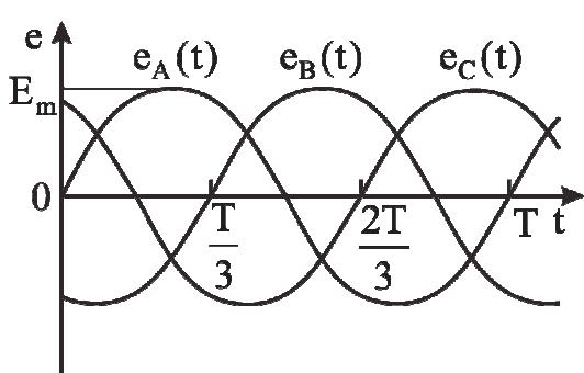
Рис. 3.1. Временные диаграммы трехфазной симметричной системы ЭДС
