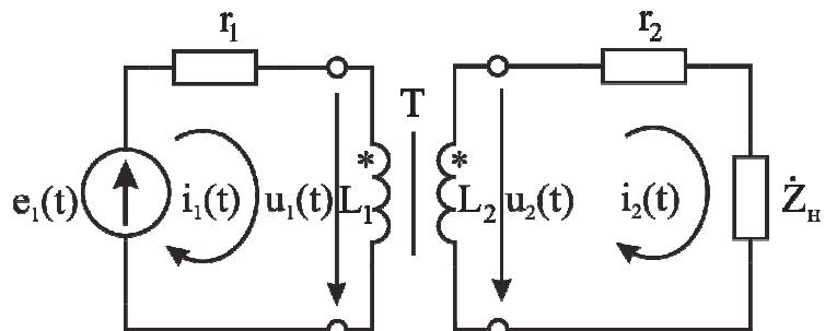
Рис. 2.7. Включение трансформатора в цепь
