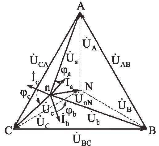
Рис. 3.12. Векторнотопографическая диаграмма трехпроводного соединения «звезда» при несимметричной нагрузке
