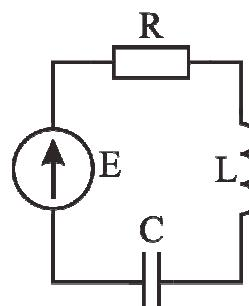
Рис. 7.1. Последовательный колебательный контур
