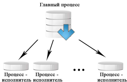
Рисунок 1 - Схема глобального однопопуляционного параллельного ГА. Главный процесс содержит текущую популяцию, выполняет генетические операторы и распределяет задания по процессам-исполнителям. Процессы-исполнители вычисляют значение функции полезности для назначенных особей популяции.
