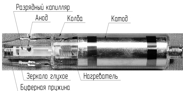
Рисунок 8 – Активный элемент двухчастотного стабилизированного He-Ne лазера Agilent 5517 (США)
