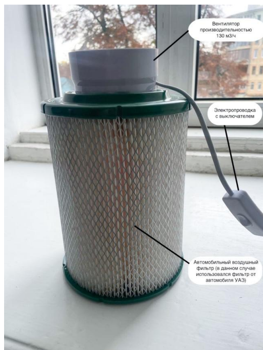
Рис. 2 – Воздушный фильтр на основе автомобильного фильтрующего элемента BIG Filter GB-76 (для легкового автомобиля) и канального вентилятора (авторская разработка, 2025г.)
