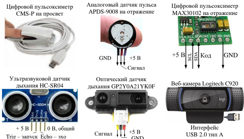
Рис. 1 – Датчики для регистрации процессов сердцебиения, сатурации, артериального давления и дыхания пациента
