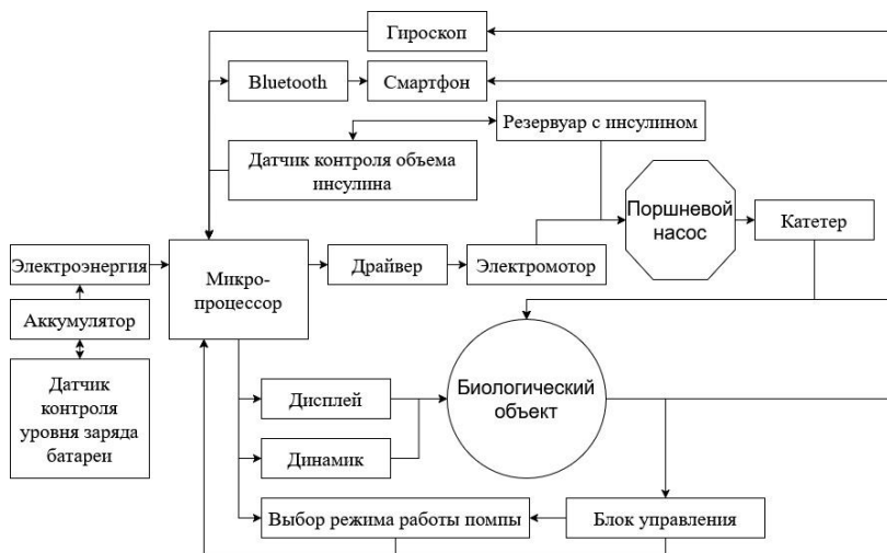
Рис. 3 – Принципиальная схема инсулиновой помпы с добавлением гироскопа
