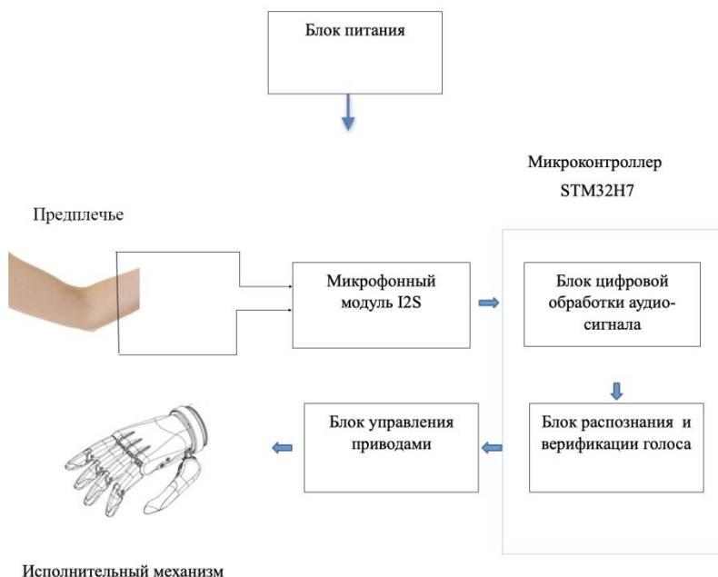
Рис.1 – Структурная схема протеза верхних конечностей на голосовом управлении
