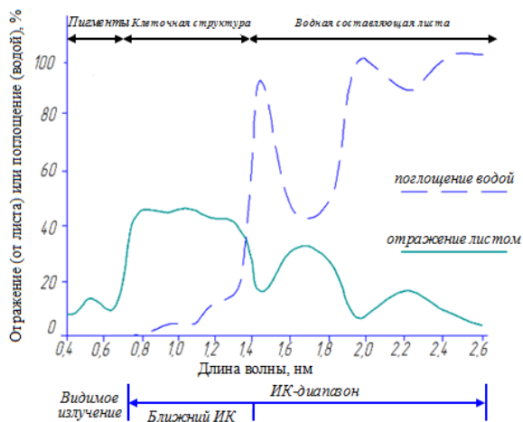
Рис. 2 – Характеристический спектр отражения зеленого листа с указанием факторов, влияющих на отражение
