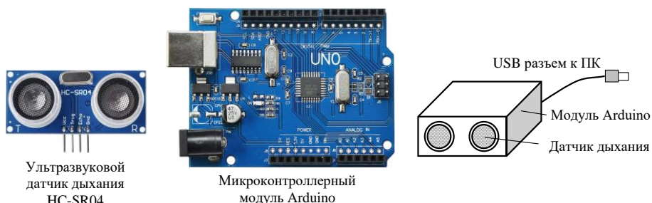
Рис. 2 – Датчик дыхания, модуль Arduino и приставка к ПК
