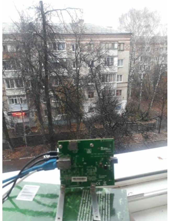
Рисунок 3.5 – Место установки РЛС AWR1642
