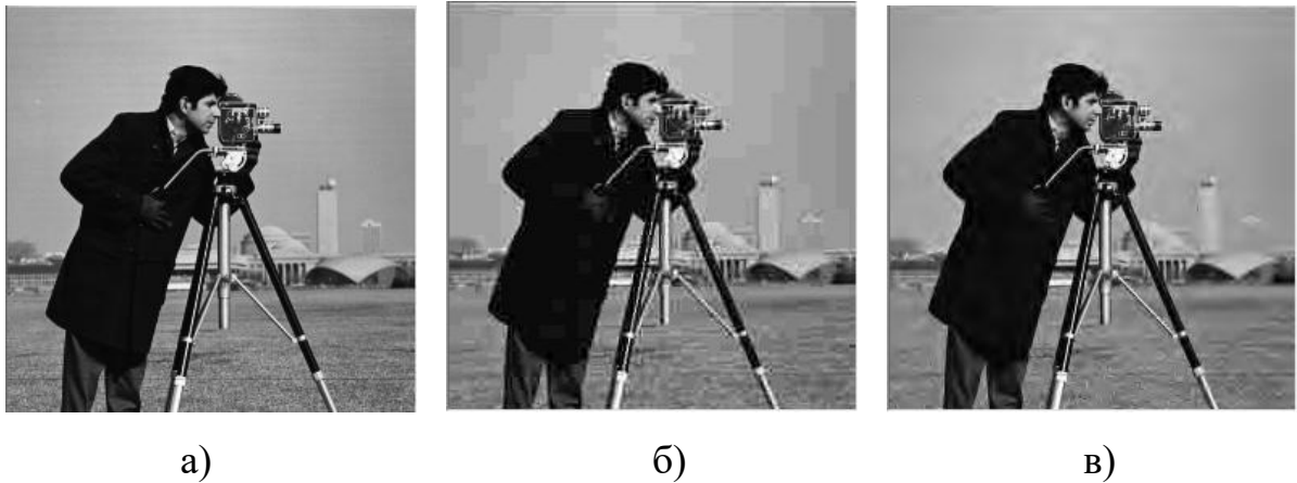
Рисунок 1.15 – Сравнение артефактов JPEG и JPEG2000 (сжатие в 20 раз)
