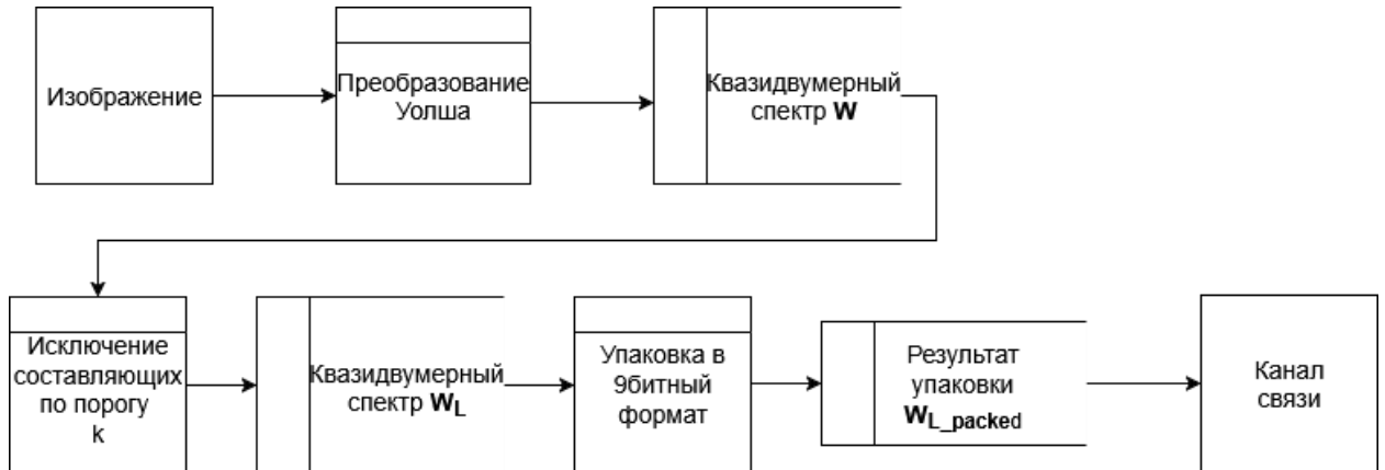
Рисунок 3.8 – Схематическое изображение алгоритма сжатия с исключением высокочастотных составляющих
