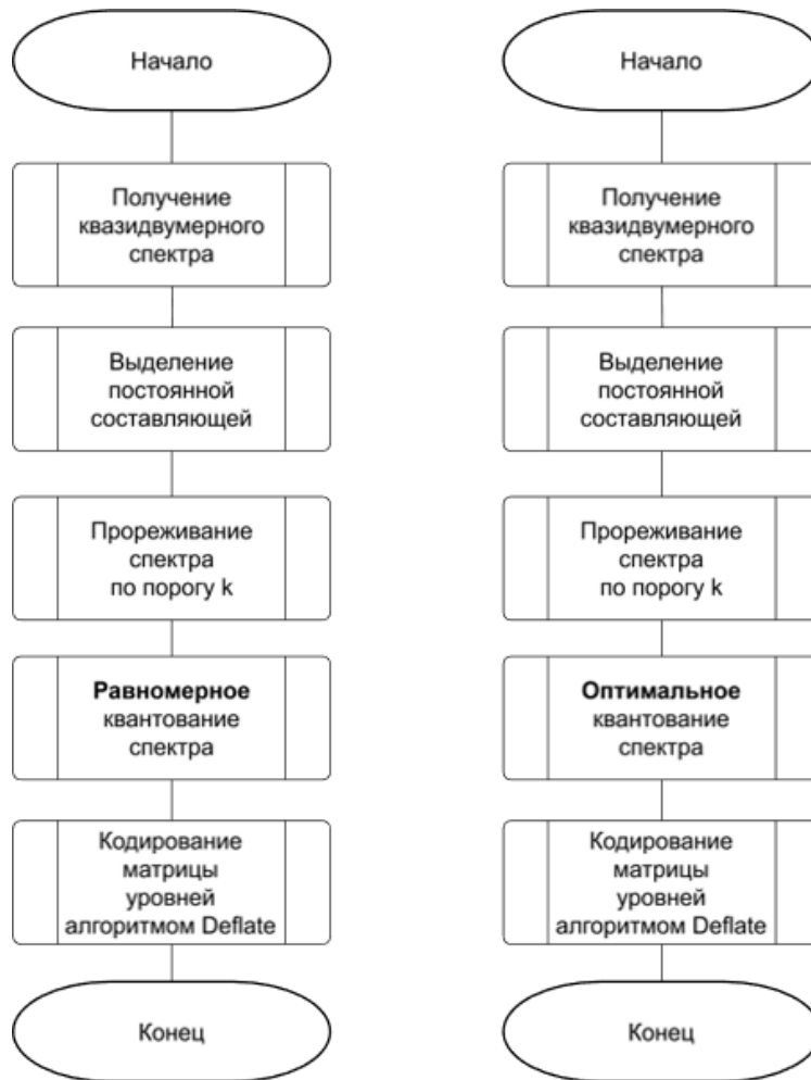
Рисунок 3.16 – Схемы алгоритмов сжатия изображений в квазидвумерном спектральном пространстве с равномерным и оптимальным квантованием составляющих
