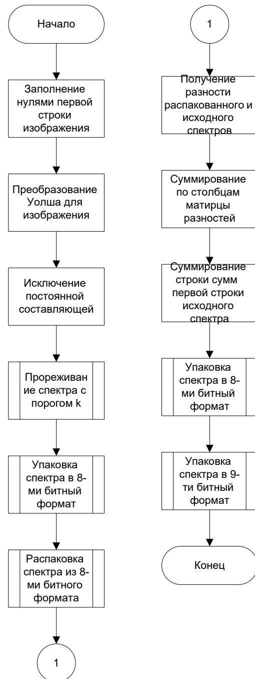
Рисунок 2.15 – Общая схема алгоритма сжатия изображения с учётом потерь при упаковке
