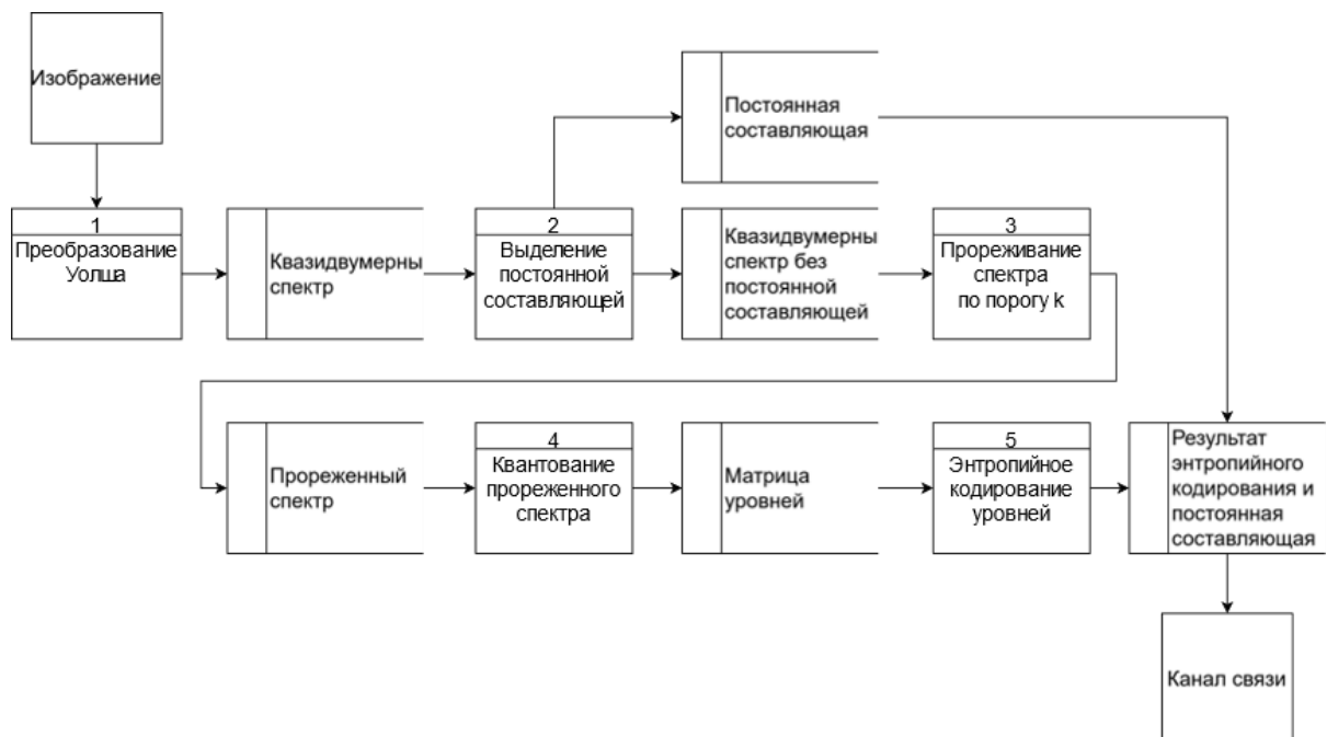
Рисунок 3.15 – Диаграмма потоков данных предложенного метода сжатия изображения
