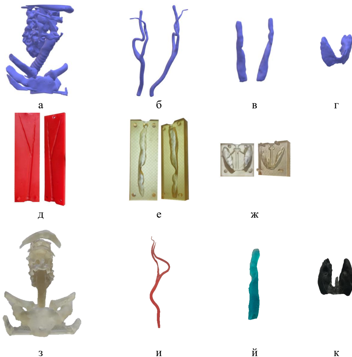
Рисунок 92 – Иллюстрации изготовления фантома шеи: сегментированные из данных ангиографической компьютерной томографии виртуальные модели костных структур (а), сонных артерий (б), вен (в), щитовидной железы (г), формы для литья артерий (д), вен (е) и щитовидной железы (ж), 3D-печатные костные структуры (з), сонные артерии (и), вены (й) и щитовидная железа (к) после извлечения из форм
