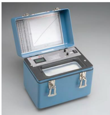
Рисунок 43 – Внешний вид и схема фантома Gammex 1430 LE Mini-Doppler: модели кист (1), модель сосуда (2), группа объектов для проверки пространственного разрешения (3), группа объектов для проверки контрастного разрешения (4), объекты для оценки «мертвой зоны» (5), нейлоновые нити диаметром 100 мкм, расположенные горизонтально у поверхности (6), в центре (7) и вертикально (8)
