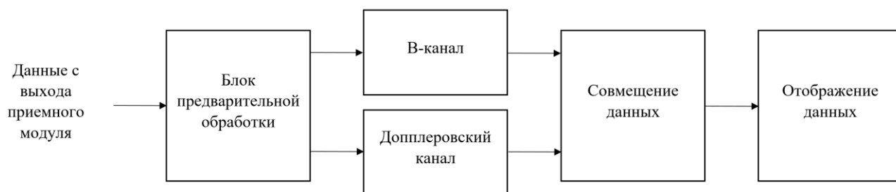
Рисунок 54 – Укрупненная схема структуры имитационной модели сканера
