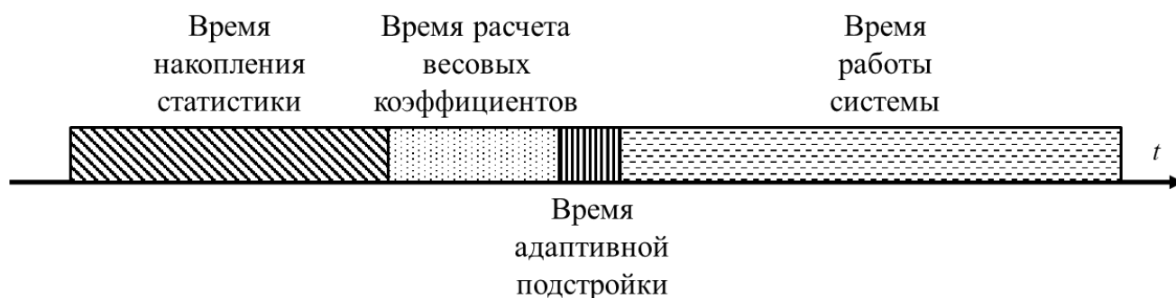
Рисунок 4.5 – Временная диаграмма работы алгоритмов обработки сигналов на фоне комплекса помех
