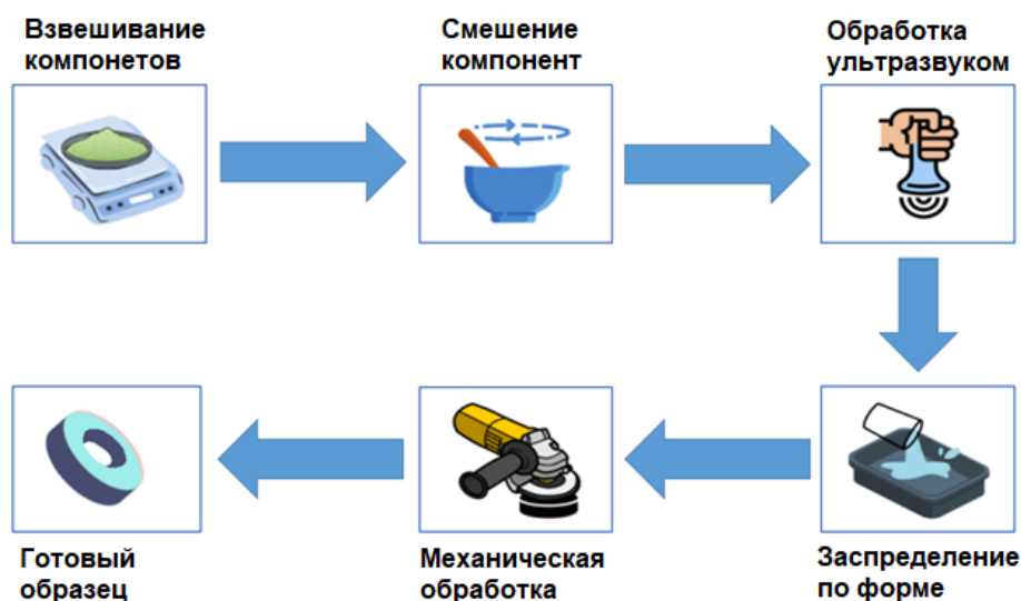
Рис. 2. Схема процесса изготовления образцов
