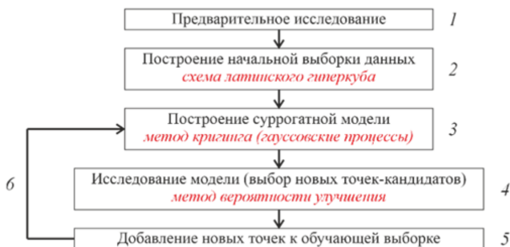
Рис. 2. Общая схема метода исследования функции с использованием суррогатной модели
