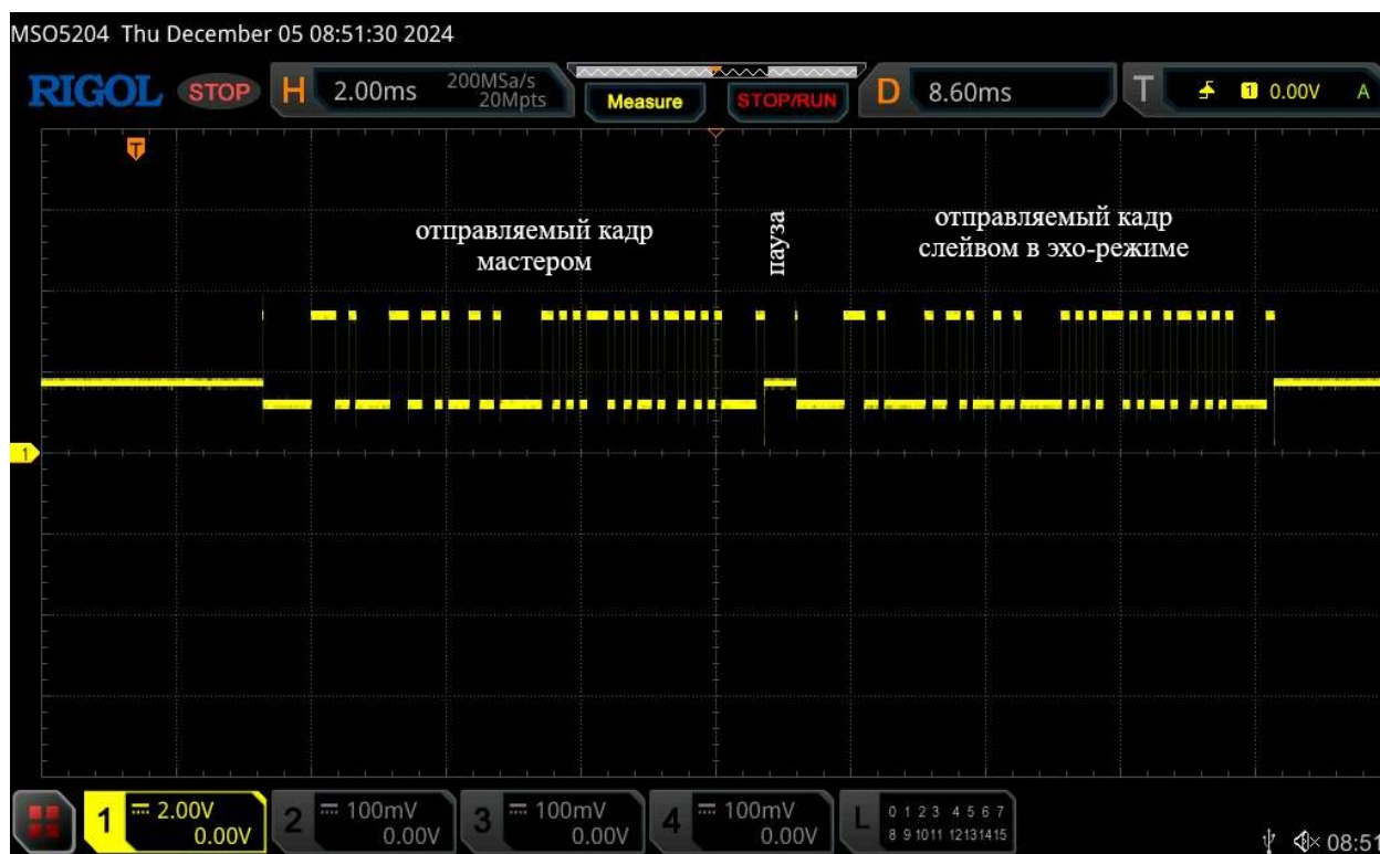
Рис. 2. Осциллограммы с приемом и передачей данных по линии А относительно земли
