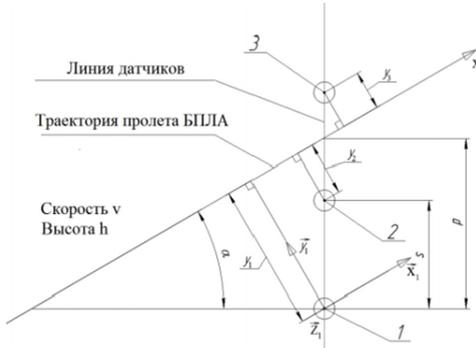
Рис. 2 — Условие электростатической задачи движения БПЛА (вид сверху)
