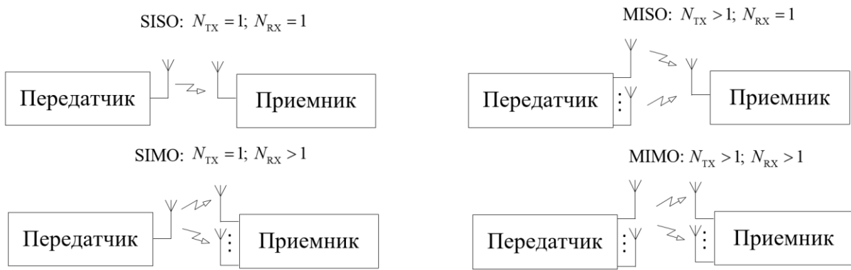
Рис. 1.1. Пространственная структура приемо-передающей системы
