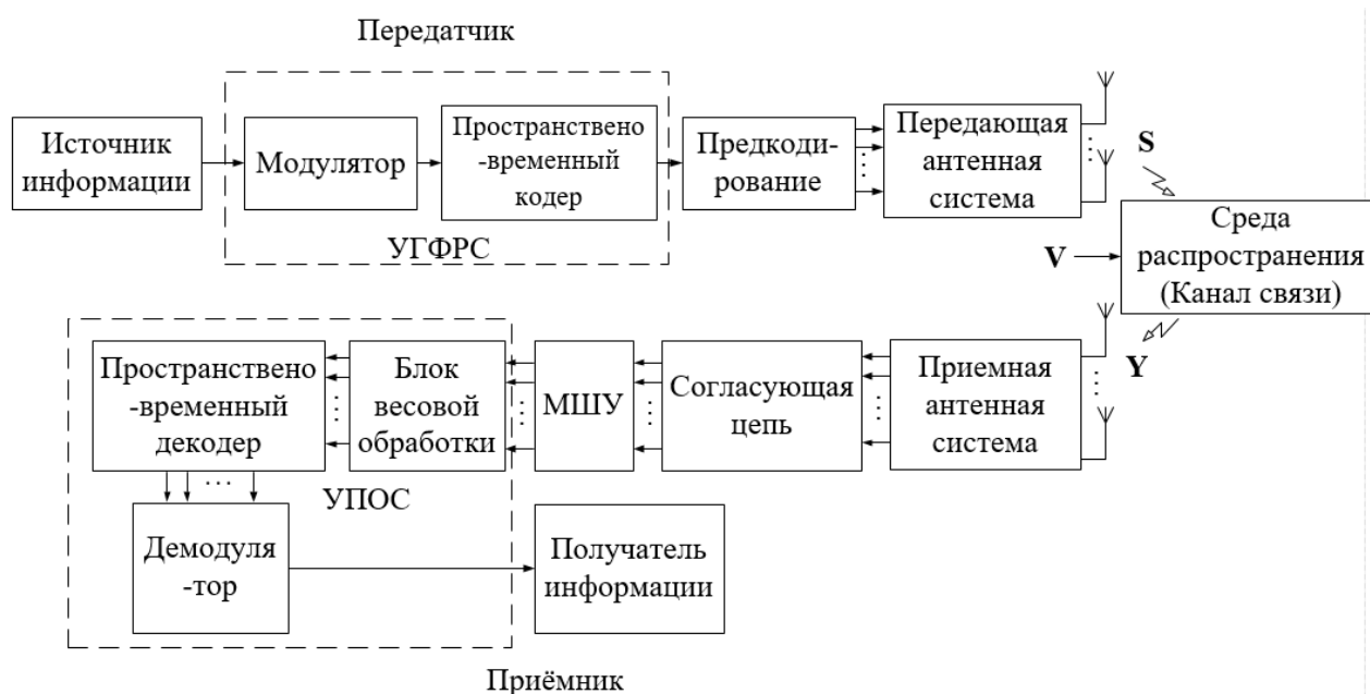
Рис. 1.4. Структурная схема MIMO системы
