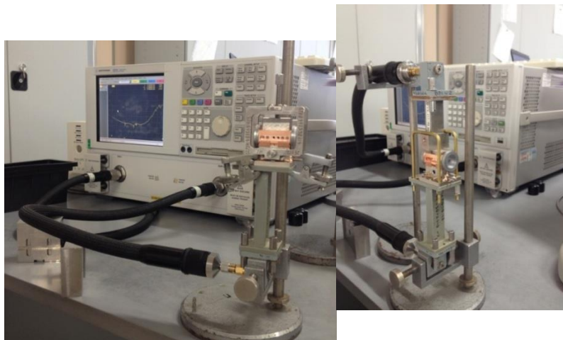
Рисунок 56 – Исследование резонаторного блока НМЛК на установке «холодных измерений»
