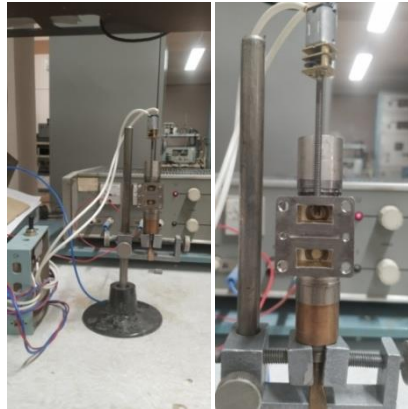
Рисунок 65 – Настройка фильтровой системы на этапе «холодных» измерений с использованием электродвигателя
