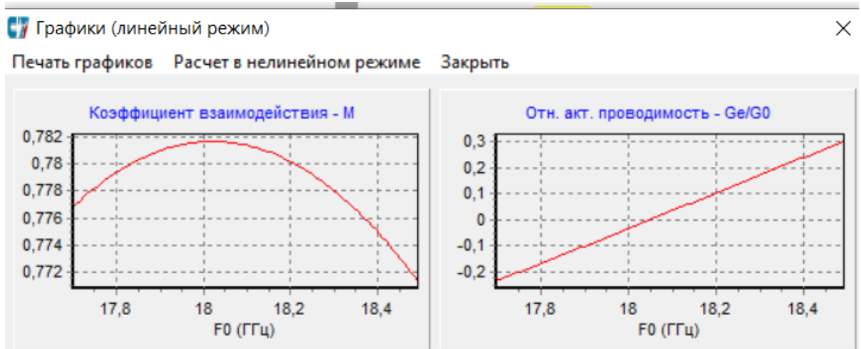
Рисунок 47 – Зависимости коэффициента эффективности взаимодействия и относительной электронной проводимости для синфазного вида колебаний от частоты сигнала в рабочей полосе частот
