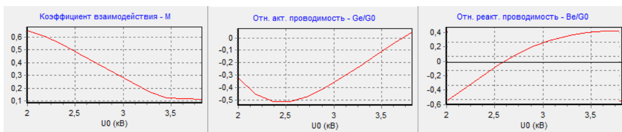
Рисунок 81 – Расчетные зависимости параметров электронного взаимодействия на противофазном виде колебаний от ускоряющего напряжения
