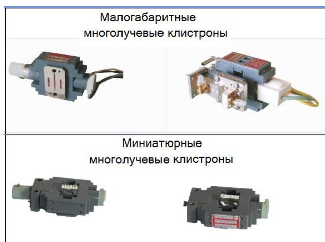
Рисунок 1 – Внешний вид малогабаритных и миниатюрных клистронов
