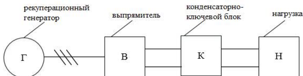
Рис. 4. Структурная схема повышающего преобразователя
