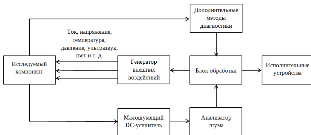
Рис. 1. Схема диагностики качества и надежности электронных компонентов по их характеристикам в области 1/f шума [1]
