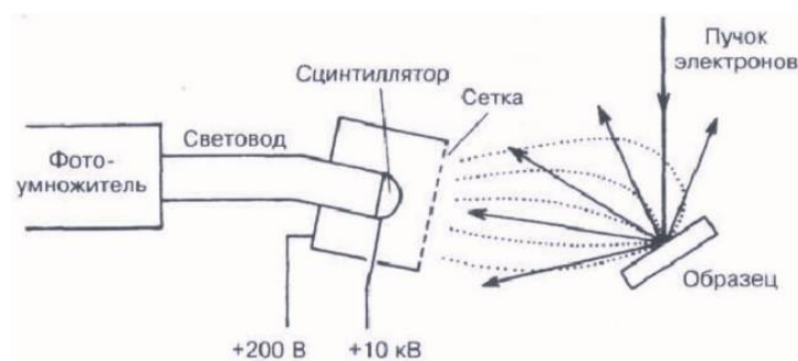
Рис. 5. Схема детектирования электронов при взаимодействии электронного пучка с образцом [9]
