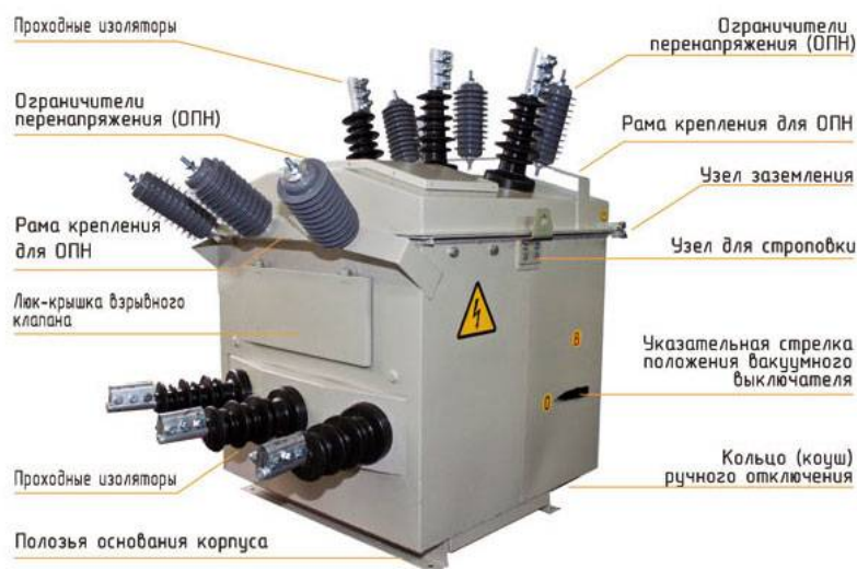
Рис. 6. Структура реклоузера
