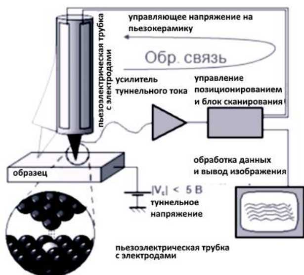
Рис. 7. Схема работы СТМ [11]
