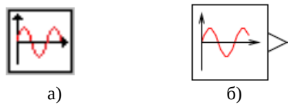
Рис. 2. Обозначение блока синусоиды в SimInTech: а) в палитре; б) на схеме
