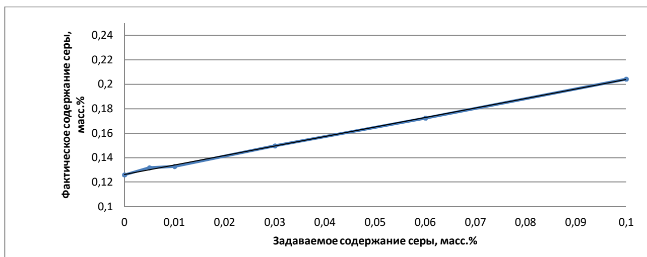
Рис. 2. Градуировочный график для диапазона значений серы 0 – 0,1 %
