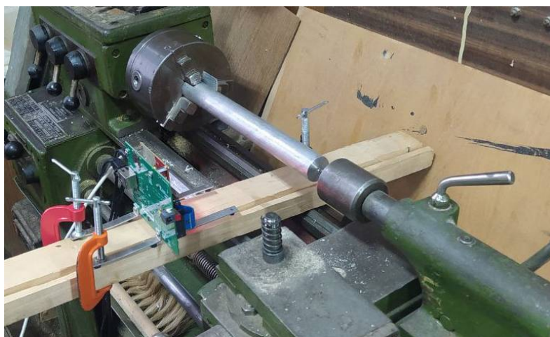
Рис. 2. Экспериментальный стенд на базе токарного станка
