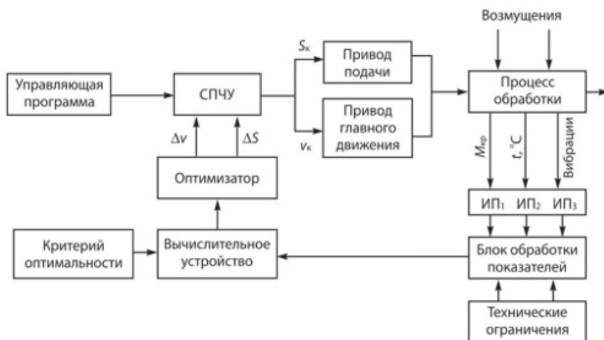
Рисунок 2 – Схема адаптивной системы оптимального управления
