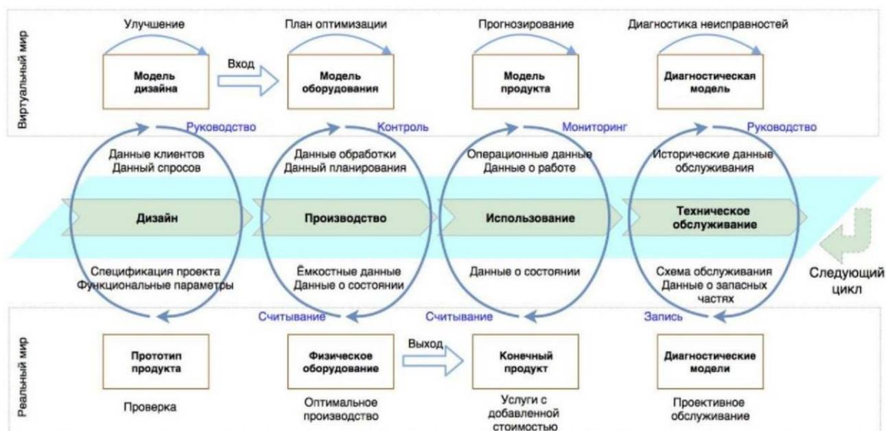
Рис. 1. Цифровой двойник объединяет производственные процессы
