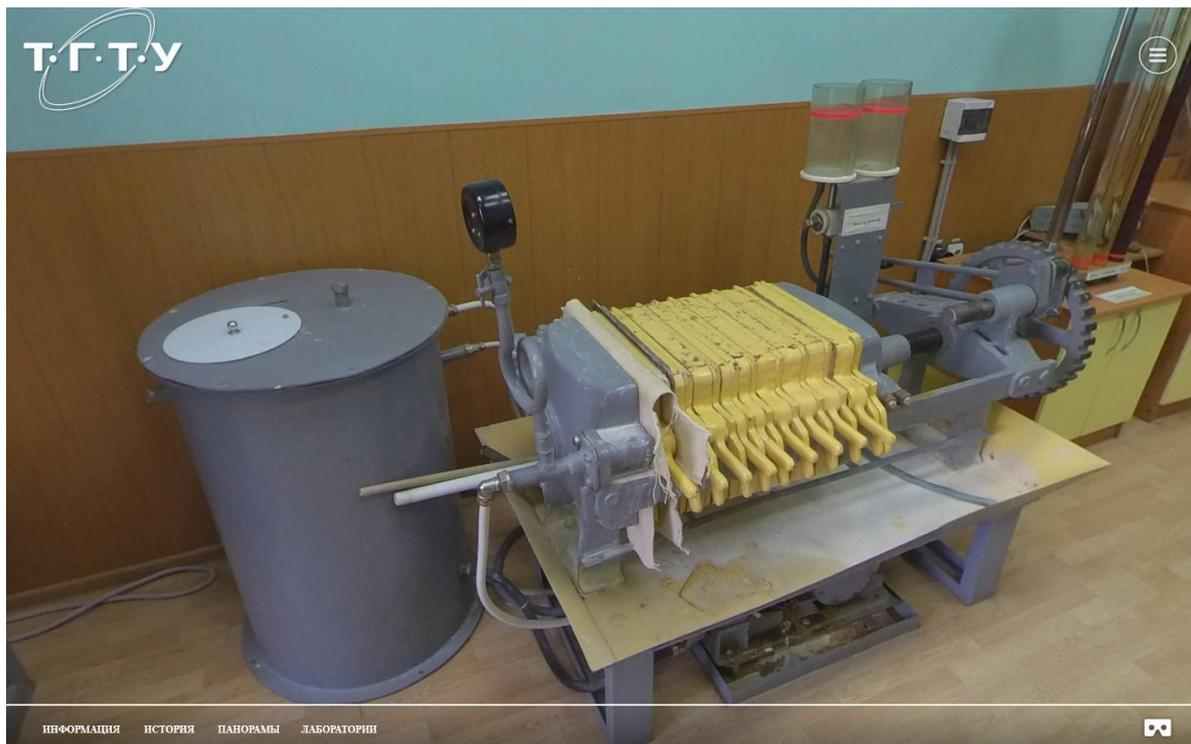
Рис. 2. Визуализация фрагмента вида лаборатории с установкой фильтрации суспензии
