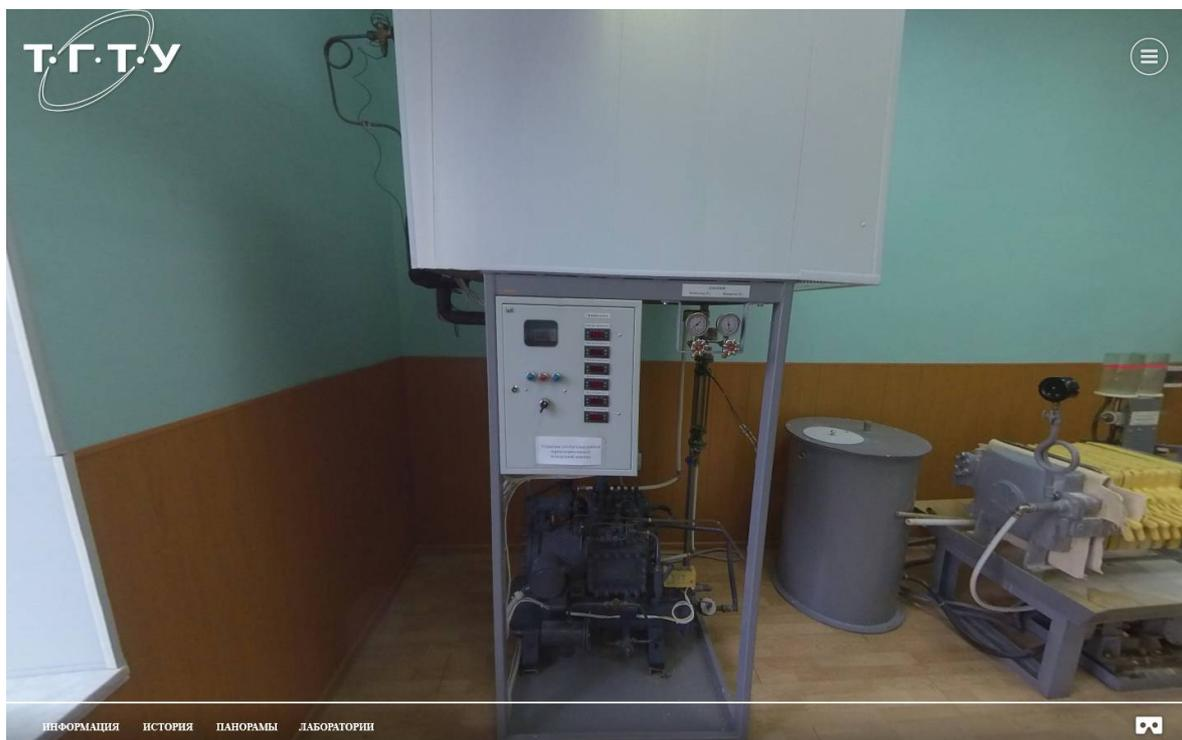
Рис. 3. Визуализация фрагмента вида лаборатории с установкой для изучения парокompрессионной холодильной машины
