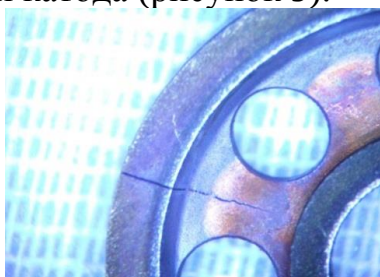
Рисунок 9 – Разрушенный катодный узел после вскрытия опытного амплитрона
