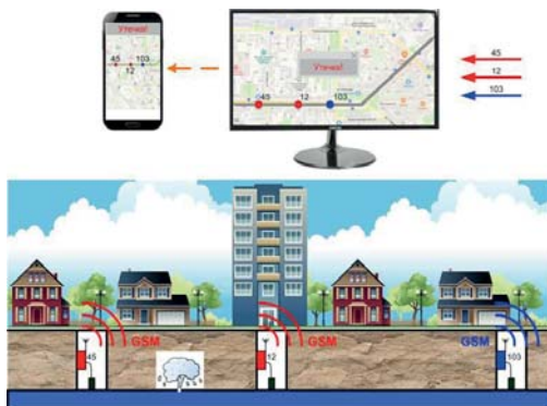
Рисунок 2 - Интеллектуальный акустический мониторинг трубопровода
