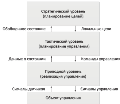
Рисунок 2 – Структура взаимодействия оборудования стратегического, тактического и приводного уровней
