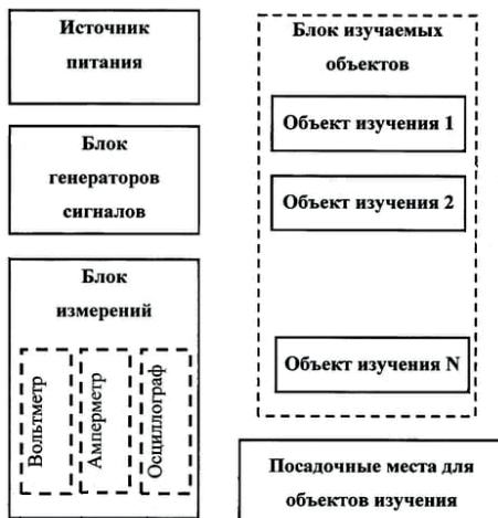
Рисунок 1. Структурная схема учебного стенда по электронике [3]
