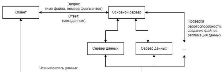
Рисунок 1 - архитектура распределенной файловой системы
