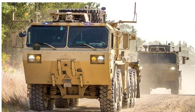
Рис. 1 – Испытания автономного тягача Oshkosh PLS M1075A1, оснащенного системой слежения за ведущим
