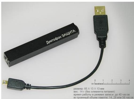
Рис. 1 – Внешний вид специализированного диктофона «Защита»
