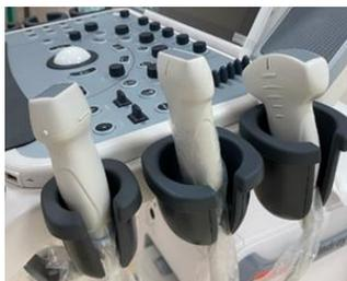
Рис. 2 – Секторный, фазированный и линейный датчик.
