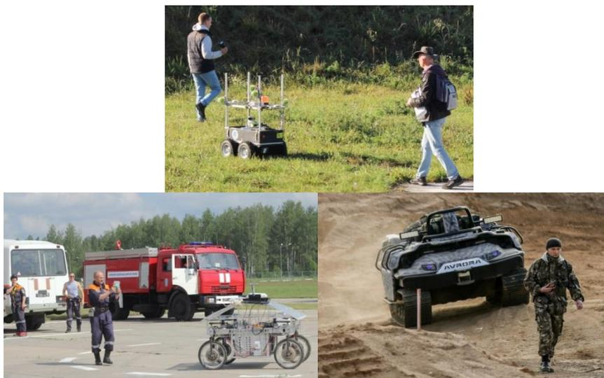
Рис. 4 – Размещение системы слежения за ведущим на робототехнических платформах: мобильный робот типа «Вомбат», отладочная мобильная платформа с четырьмя независимыми поворотными ведущими мотор-колесами, робототехнический комплекс МАРС А-800
