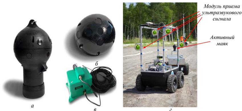
Рис. 2 – Система слежения за ведущим: а – активный маяк, б – модуль приема ультразвукового сигнала, в – модуль синхронизации и сбора данных, г – пример размещения системы на двух мобильных роботах типа «Вомбат»
