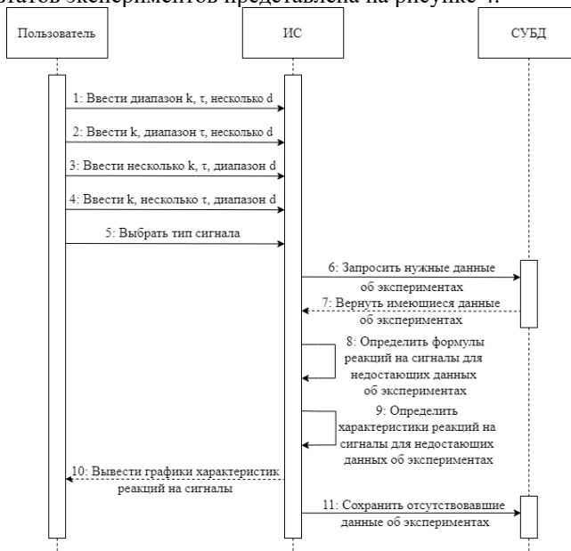
Рис. 4. Модифицированный процесс сравнения характеристик
