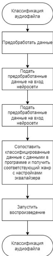
Рис. 3. Обобщённый алгоритм классификации аудиоданных
