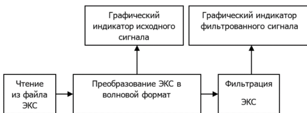
Рис. 1. Структурная схема фильтрации сигнала ЭКГ.
