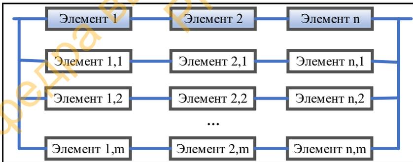
Рис. 3.2. Общее резервирование последовательного соединения
