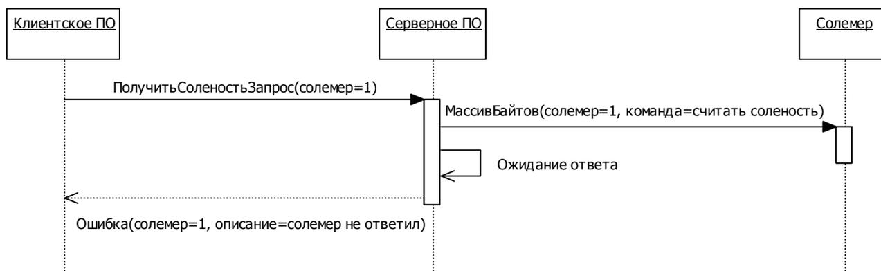
Рис. 2. Диаграмма последовательности считывания соледержания с солемера, который не отвечает или не подключен к серверу
