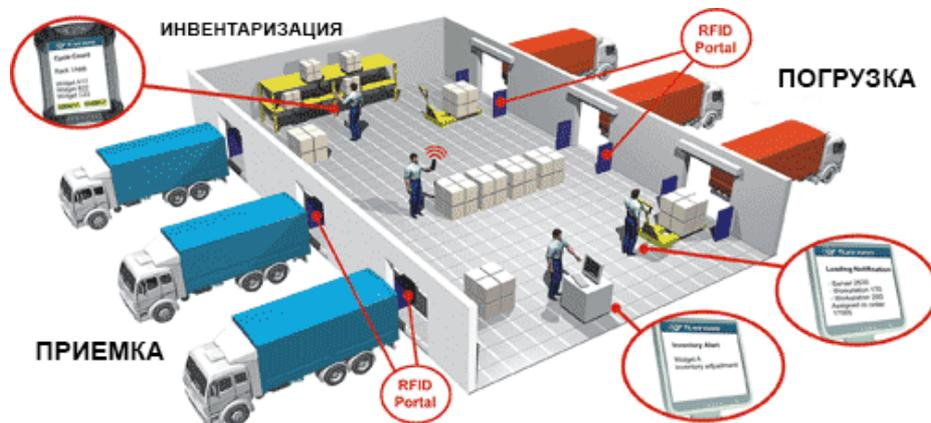
Рис. 5. Схема работы на складе с RFID
