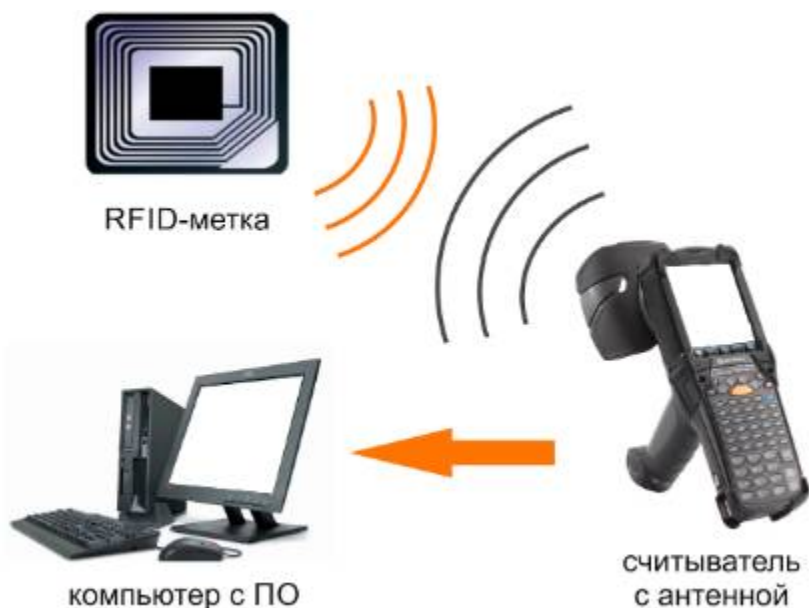
Рис. Принцип работы RFID-системы
