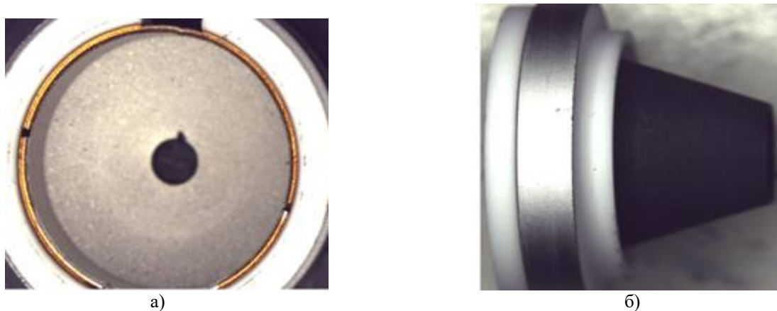
Рис. 4. Спаянные узлы: МПГ 7 –BK94-2 с металлизацией Mo (а), и Ni (б)
