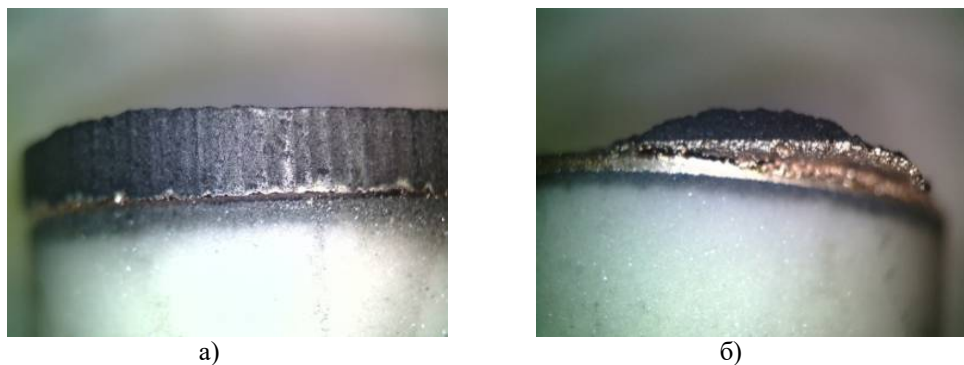
Рис 2 .Торцевой спай стержня из МПГ 7 с металлизацией пленкой из молибдена и керамики BK94-2 (а), торцевой спай стержня из МИГ 2 с металлизацией из молибдена и керамики BK94-2 (б)
