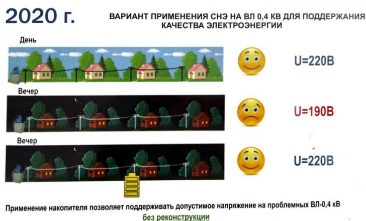
Рис. 3. Вариант применения СНЭ на ВЛ 0,4 кВ для поддержания качества электроэнергии
