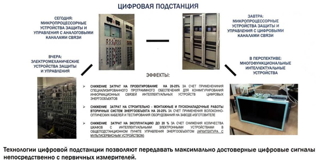
Рис. 4. Реконструкция ПС 110/10 кВ по технологии цифровых подстанций
