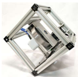
Рисунок 7. Система стабилизации гироскопом куба, балансирующего на грани
