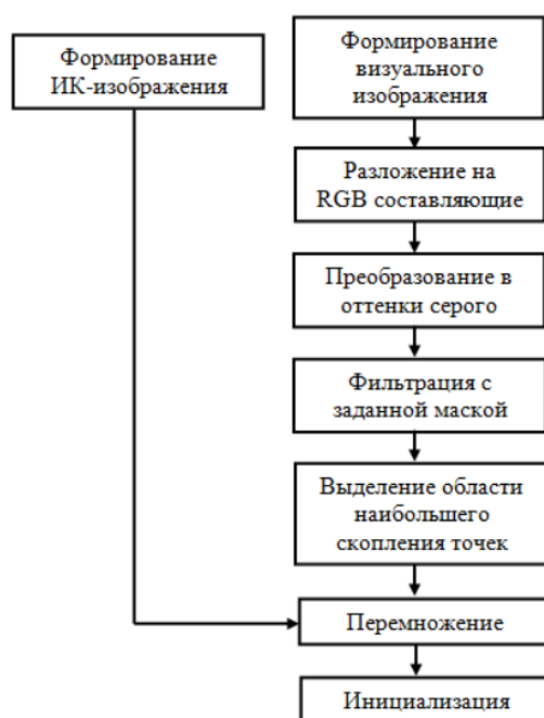
Рис. 2. Алгоритм комплексирования ТВ- и ИК- изображений
