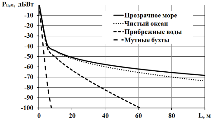
Рис. 1. Зависимости принятой мощности от дальности для разных типов морской воды
