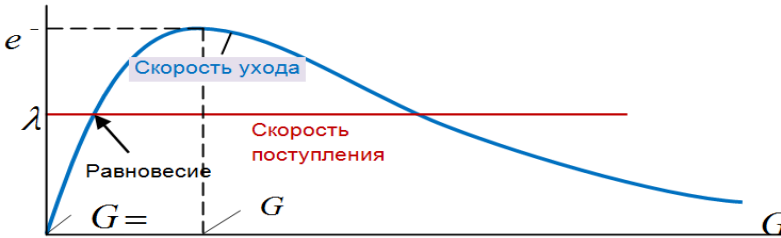
Рис. 1. Скорость ухода пакетов как функция интенсивности попыток передач для системы синхронная ALOHA
