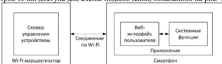
Рис. 1. Схема взаимодействия маршрутизатора и клиента
